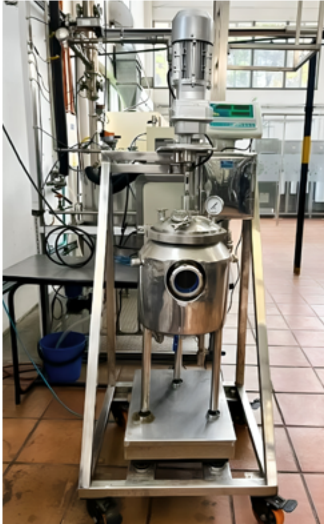
Reactor de Tanque Agitado acoplado a una balanza.
