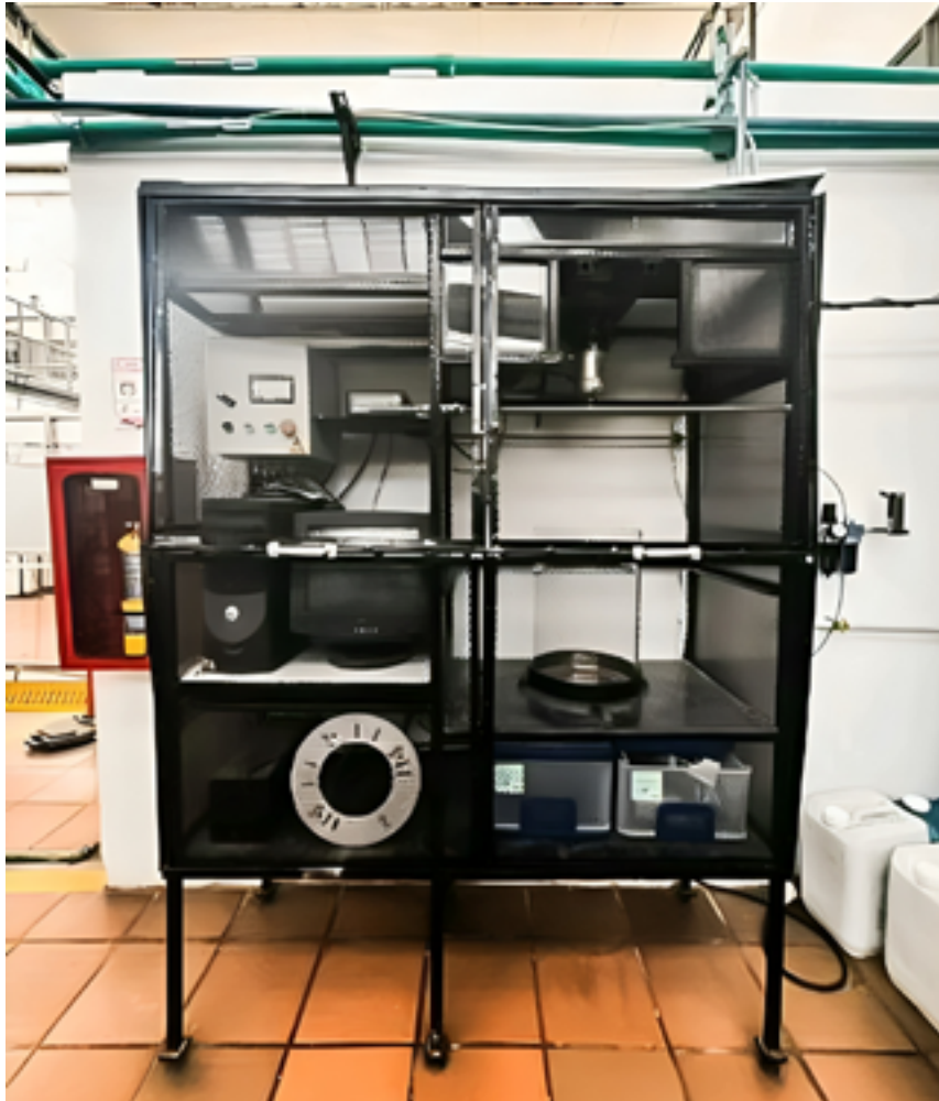
Tanque de agitación provisto con accesorios para agitador y baffles. Medición de velocidad de agitación y potencia utilizada.
