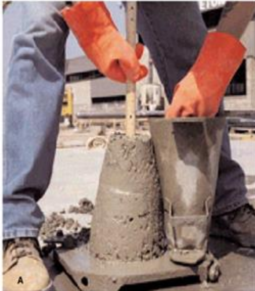
Prueba del Slump para consistencia del concreto
