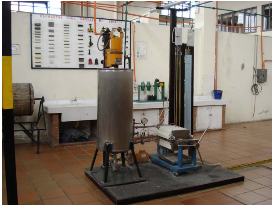
TANQUE DE ALIMENTACIÓN, FILTRO Y TABLERO DE MANÓMETROS
