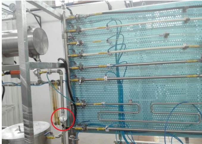
Figura 1. Termocupla, elemento primario de medida para control de temperatura.
